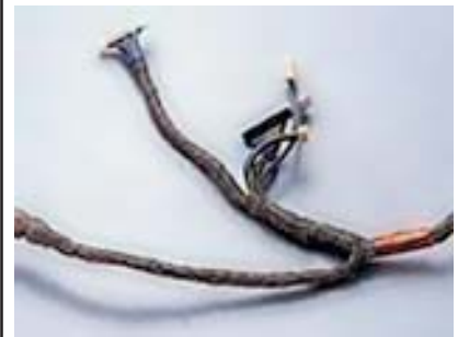
Рисунок 13 Экранирование (а) и жгутирование (б) проводов при помощи оплеток
