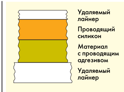
Рисунок 16 Структура ленты CS-2400
